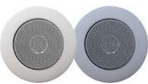
P7112 4/10 W - 8 Ohm - 84 dB (1w 1m) Respuesta en frec. 150-20000 Hz Para empotrar en falso techo. Dimensiones: Ø 80x32 mm Agujero instalación: 60 mm Fijación con muelles
